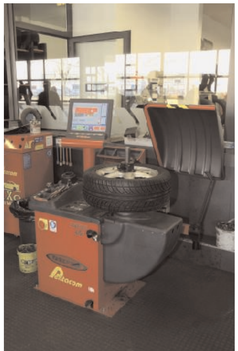
La macchina V651 nel suo complesso è pronta per l'equilibratura del pneumatico. Il display è di tipo LCD 15" a colori con interfaccia grafica interattiva con comandi a icone
